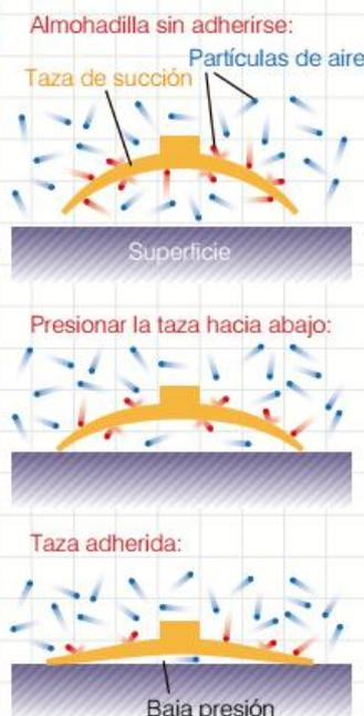
Hay muchas más partículas de aire por unidad de volumen en el exterior de la taza que en el interior, entonces la presión es mucho mayor en el exterior que en el interior. Esta diferencia en la presión del aire es lo que mantiene a la almohadilla adherida a una superficie.
