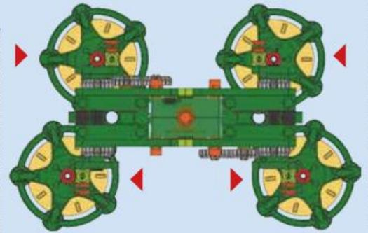
**¡TIP!** A este punto deberías asegurarte de que las patas del Geckobot pueden realizar una rotación completa. Asegúrate de que los ejes que sujetan las patas al cuerpo no estén demasiado salidos ya que podrían bloquear la rotación de las patas.
