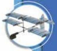
LA EFECTIVIDAD DE UN ALA DEPENDE DE MUCHOS FACTORES COMO POR EJEMPLO SU FORMA, LA SUPERFICIE, LA FORMA DEL PERFIL, EL ÁNGULO DE ATAQUE Y FACTORES ESPECIALES COMO SPOILERS, FLAPS, SLATS Y ALERONES, LA VELOCIDAD DEL PLANO, EL PESO DEL PLANO Y LA DENSIDAD DEL AIRE (LA ALTITUD A LA QUE VUELA EL PLANO). AQUÍ HAY CINCO DISEÑOS DE ALAS.
