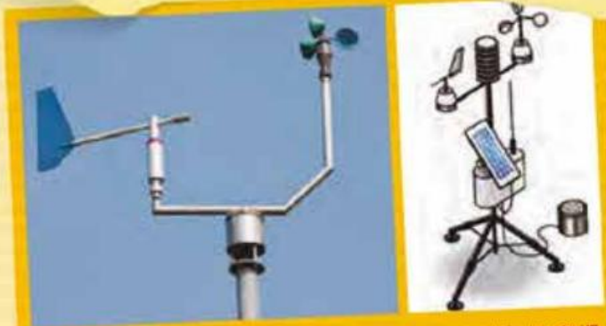
Un anemómetro es un dispositivo para medir la velocidad del viento y es un instrumento común que se encuentra en las estaciones meteorológicas. La palabra proviene de la palabra griega "anemos" que significa viento.
