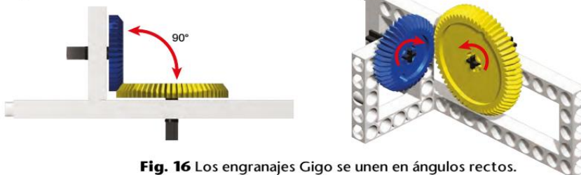
Fig. 16 Los engranajes Gigo se unen en ángulos rectos.
