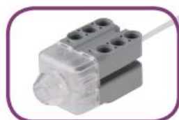
按壓感應器：是一種直接接觸物體，並回傳結果的感測器。 FORCE SENSOR
